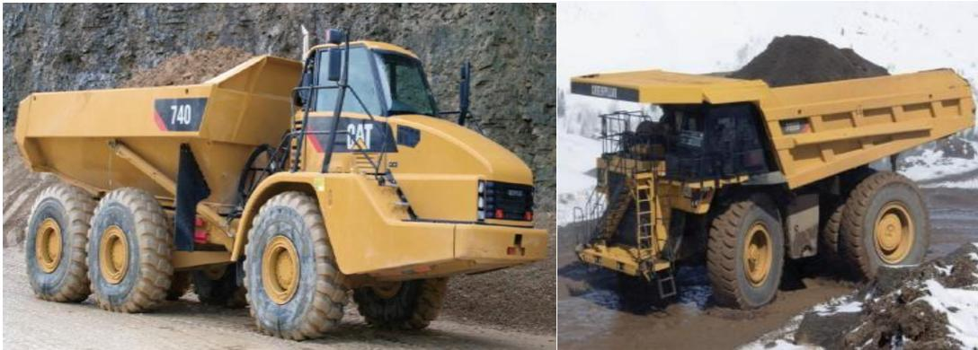
**Figura 6:** Caminhões com estrutura articulada, Caminhões com estrutura rígida
